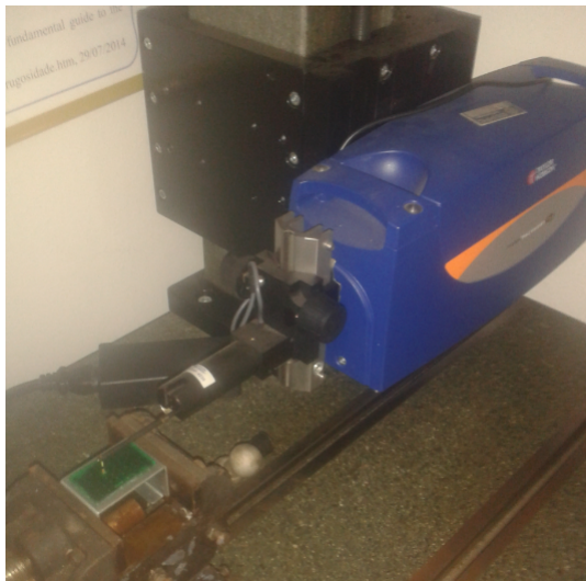
Figura 3: Perfilômetro utilizado para avaliação da geometria sem a retirada da peça da plataforma
