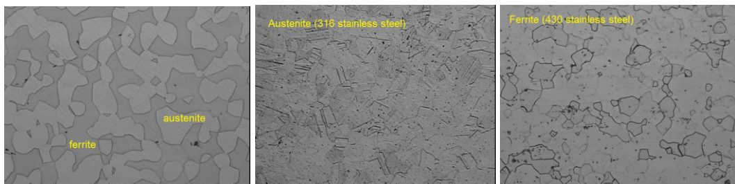
Figura 1. Micrografia ótica dos aços inoxidáveis com aumento de 500x.
