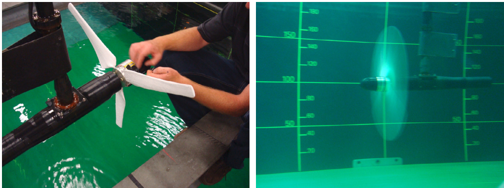
Fig. 13. Essais sur pales composites instrumentées au bassin.
