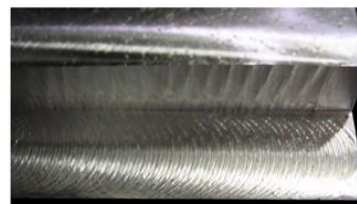
(b) Superfície usinada com a presença de chatter
