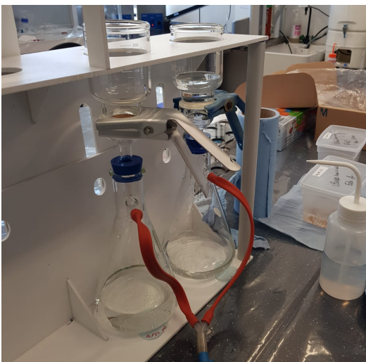
A gauche : Échantillons en cours de filtration. A droite : Quelques échantillons de poussières minérales après filtration (crédits : M. Dumont)
