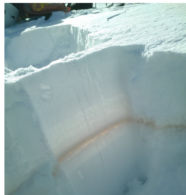
Coupe du manteau neigeux dans les Hautes Alpes environ deux semaines après le dépôt (crédits : L. Denais)
