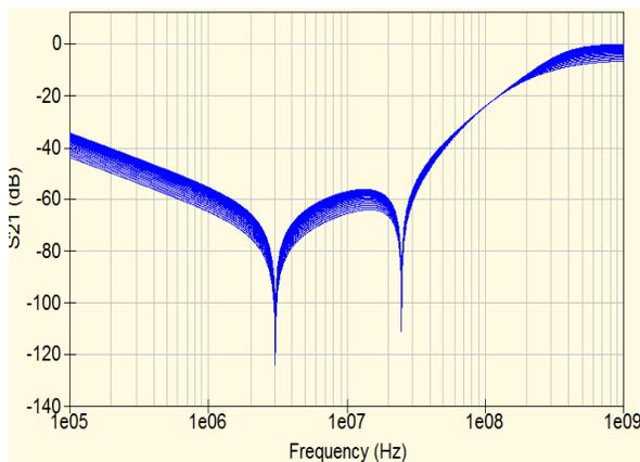
Figure 8 Simulation du gain du filtre LC avec la valeur EPR entre 1 ohm et 100 ohms
