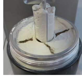
Figure 5. a) \Gamma et contrainte en fonction du taux de cisaillement ; b) Carotte formée par la géométrie vane.
