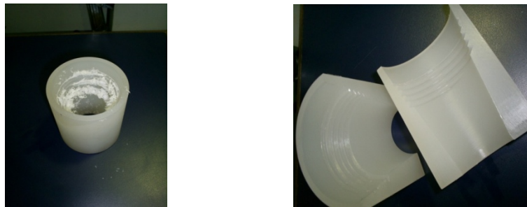
(a) Corpo de prova usinado com rebarbas (b) Corpo de prova aberto sem rebarbas
