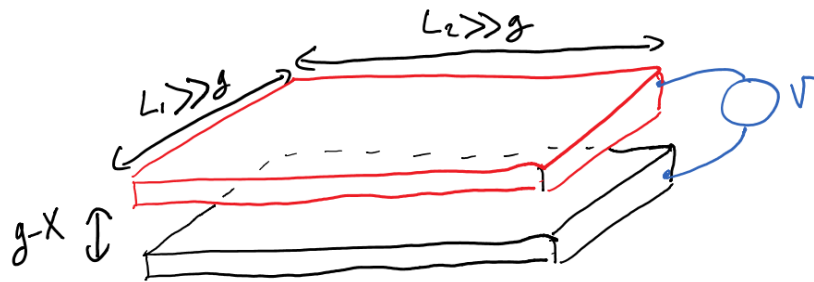
Fig. 4.20 – Géométrie « gap-closing ». L'électrode rouge est attirée vers l'électrode noire.
