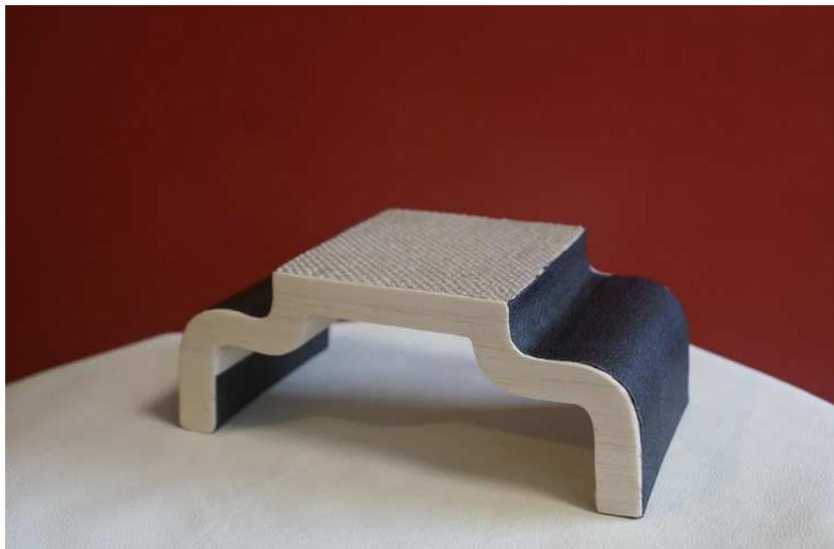
Exemple de mousses polymères biosourcées mises au point dans le cadre d'un projet du Centre des Matériaux des Mines d'Alès. Carats Innovation
