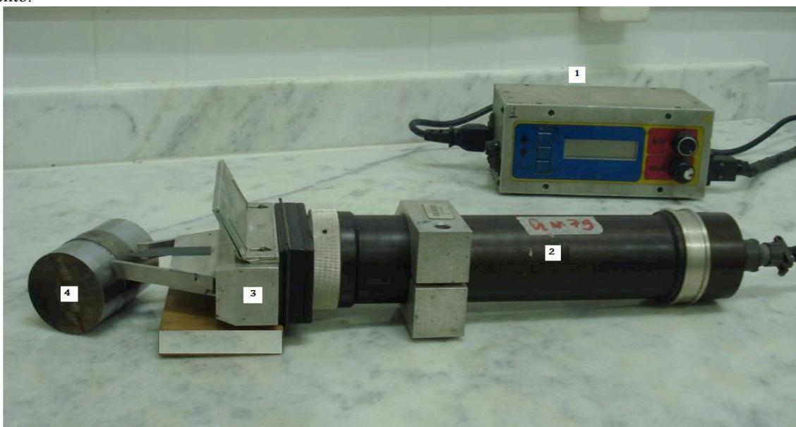
Figura 2 – Equipamento medidor portátil de tensões por difração de raios-X, composto de (1) unidade de controle de tensão e corrente; (2) tubo de raios-X com radiação  $CrK\alpha$ ; (3) colimador e (4) amostra analisada.
