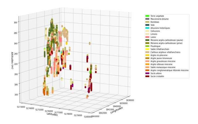
Figure 3. Visualisation 3D des sondages de la zone de Fourvière.
