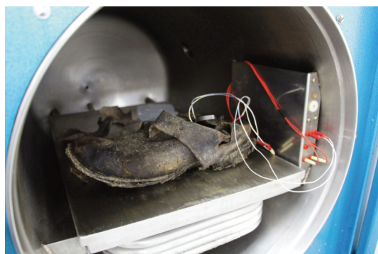
Fig. 2. Après imprégnation, la chaussure congelée est mise en place dans le lyophilisateur. Des thermocouples permettent de mesurer l'avancement du séchage. © C. Bonnot-Diconne.
