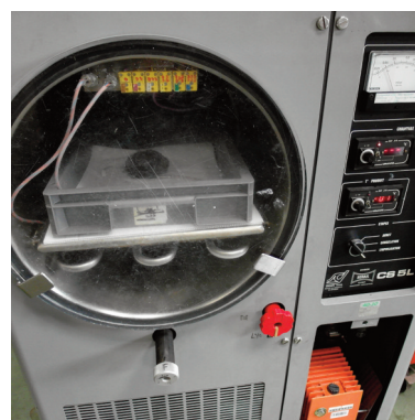
Fig. 17. Séchage de la bourse par lyophilisation après imprégnation du textile. © ARC-Nucléart.
