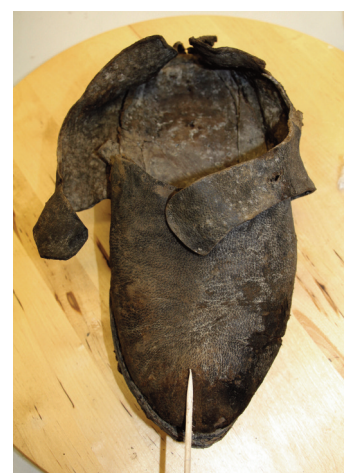
Fig. 2. Après imprégnation, la chaussure congelée est mise en place dans le lyophilisateur. Des thermocouples permettent de mesurer l'avancement du séchage. © C. Bonnot-Diconne.
