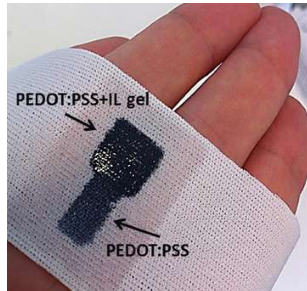
Les électrodes textiles sont identifiables par la coloration du PEDOT:PSS sur le tissu.
