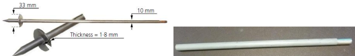
Figure 1. Pieux modèles. Exemple de pieu hélicoïdal mono-hélice en acier (à gauche, Schiavon et al. 2018) et de pieu cylindrique fermé en aluminium (D=18mm, longueur d'encastrement 250mm, El Haffar, 2018).
