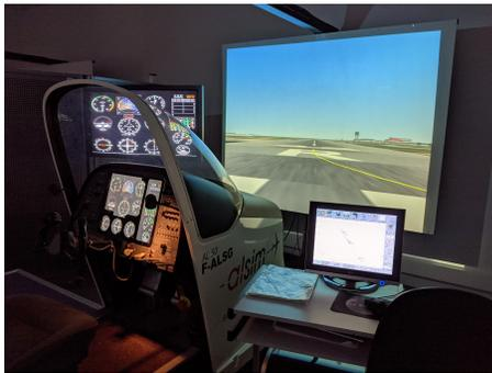
**FIGURE 1: Environnement de simulation AL50 de l'ENAC composé d'un cockpit monopilote, d'un visuel rétro-projeté et d'un poste d'expérimentateur**
