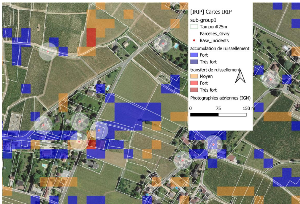
Figure 1 : Visualisation de points incidents avec leurs tampons circulaires de 25m, du parcellaire cadastral, et des aléas forts en Transfert ( \geq 3 ) et Accumulation ( \geq 4 ). (Fond satellite IGN ©)
