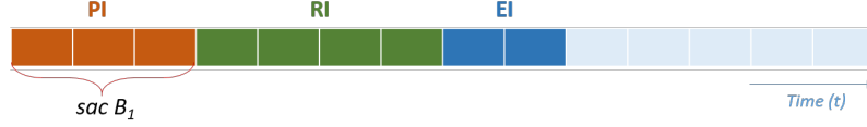
FIG. 1: Les trois paramètres appliqués pour la prédiction, produisant le sac B_1 de 3 jours
