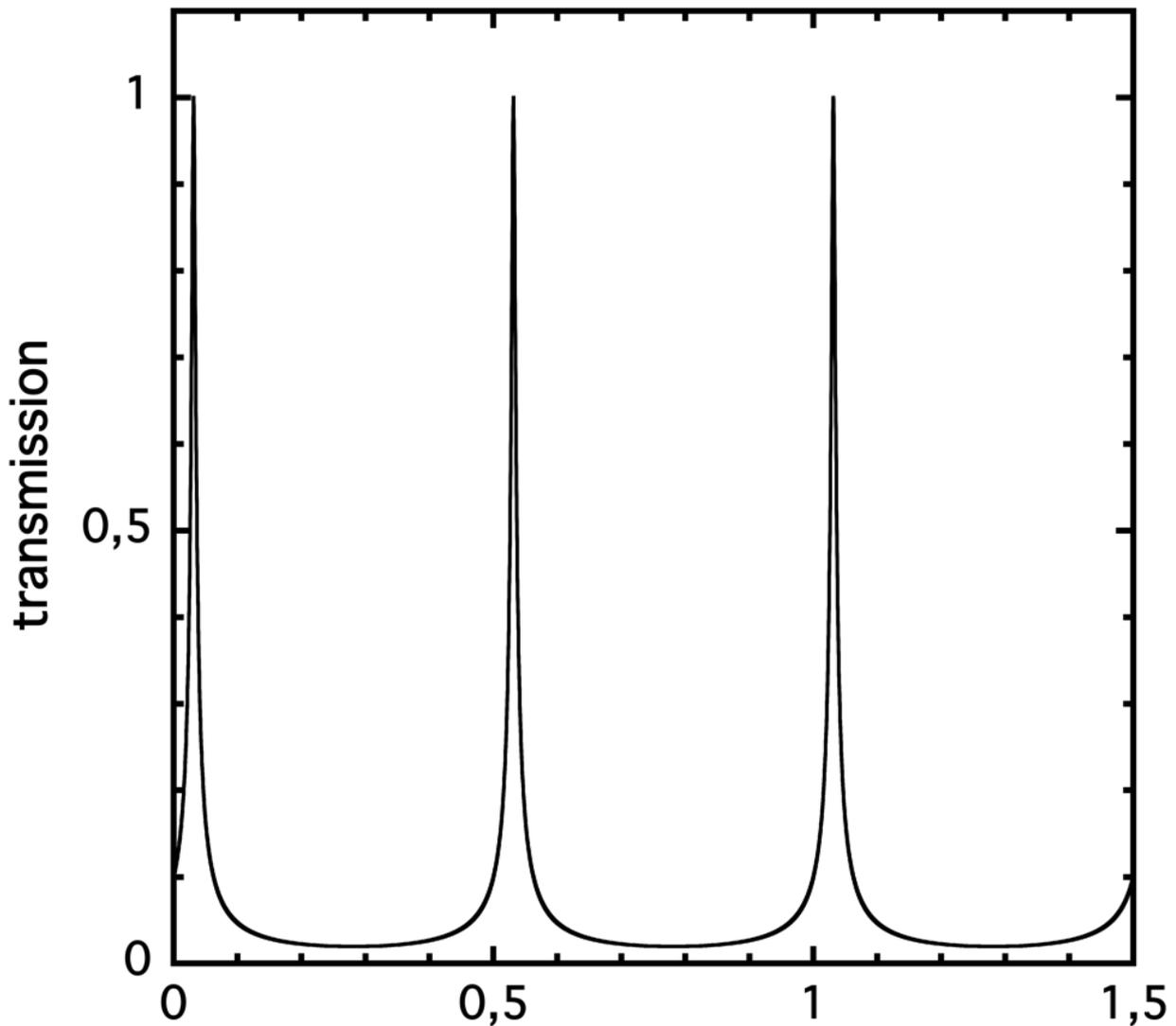
**Figure 5** - Transmission en amplitude  $|A_3/A_1|$  [cf. équation (5)] de l'interféromètre de Fabry-Pérot ultrasonore, en fonction du paramètre  $L/\lambda$  ; la figure est tracée avec  $\beta = 10$ .
