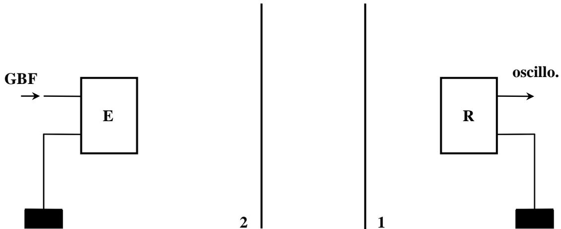
**Figure 1A** - Schéma de l'expérience. L'émetteur ultrasonore (E) est alimenté par un générateur de basses fréquences (GBF), à 40,000 kHz. La tension électrique produite par le récepteur (R) est analysée sur un oscilloscope (oscillo.). La membrane 1 est fixe ; la membrane 2 est mobile. Les positions de la membrane 2 pour lesquelles une résonance (aiguë) est observée par R, sont repérées sur une graduation au millimètre.
