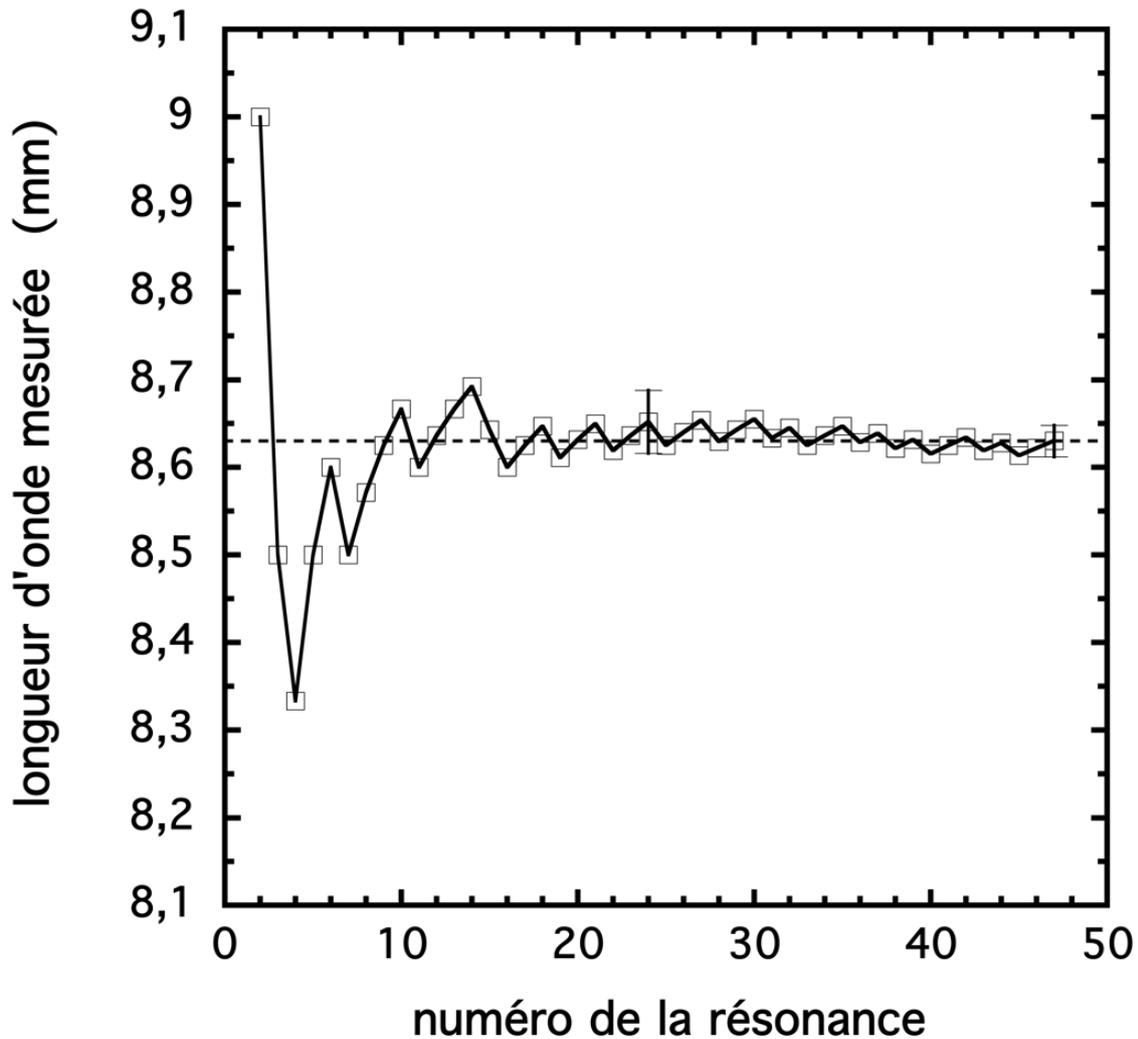
**Figure 4** - Mesure rapide de la longueur d'onde. Les carrés creux représentent la longueur d'onde  $\lambda$  estimée avec l'expression  $(n - 1)\lambda/2 = \text{position2}(n) - \text{position2}(1)$ , en fonction du numéro  $n$  de la résonance pointée en second lieu ( $n \geq 2$ ). La ligne continue brisée relie ces estimations de  $\lambda$  pour  $n$  croissant. La ligne horizontale en tirets représente la valeur  $\lambda = 8,63$  mm déterminée dans le paragraphe 2.
