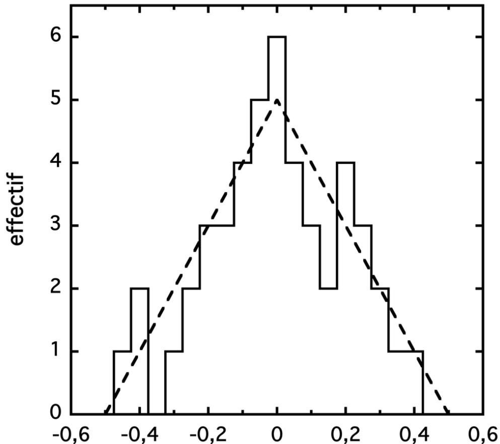
**Figure 3** - Histogramme des ‘erreurs’  $y_j^{exp} - y_j$  (en mm), établi avec un pas de 0,05 mm (ligne continue). La distribution des ‘erreurs’ est modélisée par un profil en triangle (ligne en tirets). On en déduit l’incertitude-type effective de l’expérience :  $\sigma_{exp} = (0,5 \text{ mm})/\sqrt{6} = 0,20 \text{ mm}$ .
