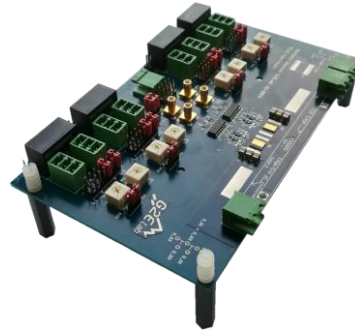
Fig. 16. Module PCoC GaN, sans refroidisseur, à comparer avec une réalisation planaire conventionnelle comme celle indiquée en Fig. 8.
