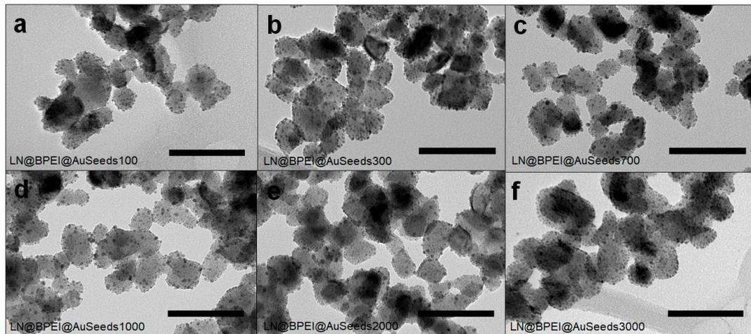
**Figure 2.** TEM images of gold seeds attached to LN NPs, at different gold seed loading densities. (a) LN@BPEI@AuScheme 100. (b) LN@BPEI@AuSeeds300, (c) LN@BPEI@AuSeeds700, (d) LN@BPEI@AuSeeds1000, (e) LN@BPEI@AuSeeds2000 and (f) LN@BPEI@AuSeeds3000. Scale bar corresponds to 100 nm.
