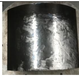
Figure 8. QUART DE VIROLE NETTOYÉE A LA PONCEUSE ORBITALE
