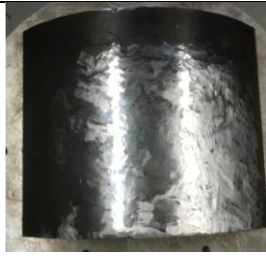
Figure 8. QUART DE VIROLE NETTOYÉE A LA PONCEUSE ORBITALE
