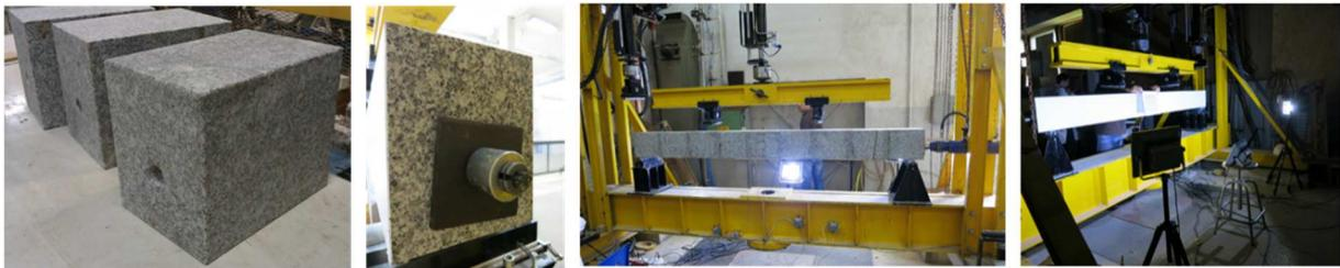
Figure 102 – Essais d'une poutre en granite précontraint
