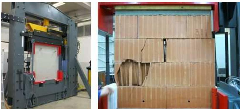
Figure 103 – Essais de murs en briques de terre cuite
