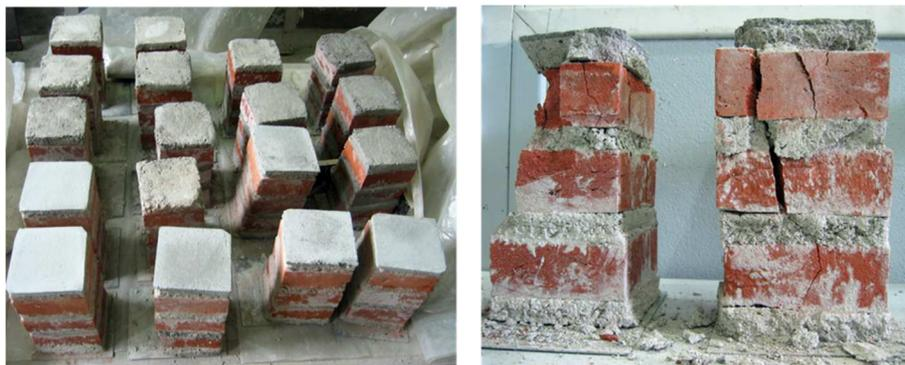
Figure 44 - Compression de multicouches de briques à 1 mois, 2 mois et après vieillissement accéléré [Domede, 2006]
