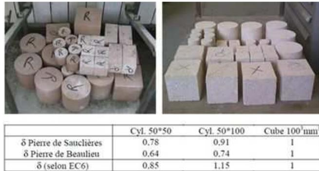
Figure 24 - Etude de l'effet de forme et d'effet d'échelle sur 2 pierres calcaires Beaulieu et Saucière.
