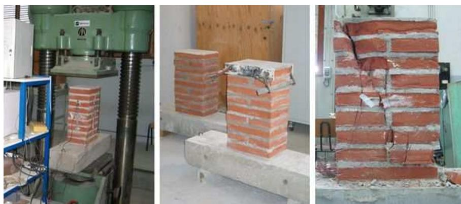
Figure 60 – Maçonnerie de briques, essais sur VER.
