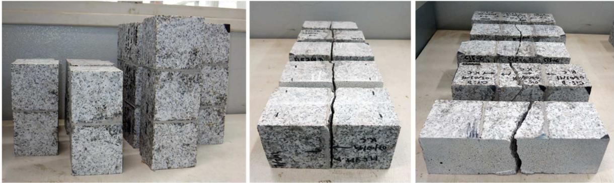
Figure 101 – Essais sur composites blocs de granite – mortier colle
