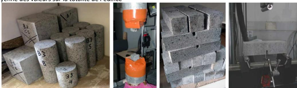
Figure 20 – Kersanton – épreuves de traction directe – flexion avec entaille
