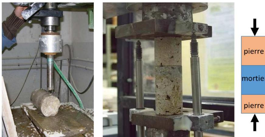
Figure 45 - Essais de compression de multicouches carottés dans la maçonnerie ancienne [Stablon, 2011]
