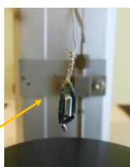
Thermobalance Setaram TG92 et plaquette d'alliage placée dans « l'araignée » pour l'essai thermogravimétrique
