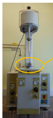
Thermobalance Setaram TG92 et plaquette d'alliage placée dans « l'araignée » pour l'essai thermogravimétrique
