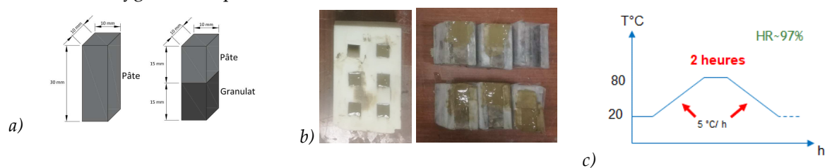
FIGURE 1. a) Dimensions des éprouvettes de pâte de ciment et de composite, b) Moules verticaux (à gauche) et horizontaux (à droite) utilisés, c) Cycle thermique et humidité relative appliqués.
