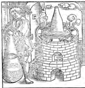
Figure 33 – Four à dissolution, De alchimia , 1541.
