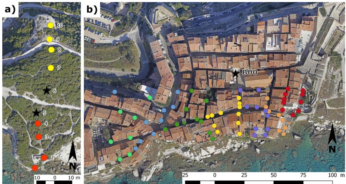
Figure 2 : a) Position des mesures en écoute sismique en octobre 2016 à Sutta Rocca (Bonifacio) et b) en janvier 2019 à la Citadelle (Bonifacio). Chaque groupe de mesures simultanées est signalé par une couleur différente. Les stations de référence, communes à tous les groupes de mesures pour un site sont signalées par des étoiles noires.
