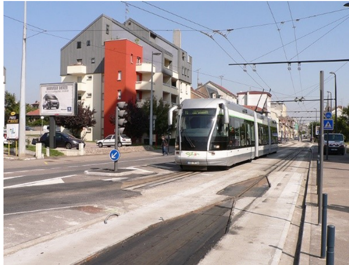
Figure 12 - Transport sur Voie Réservée (TVR) in Nancy at the mode-change point from Tram to Trolleybus, September 11, 2006.
