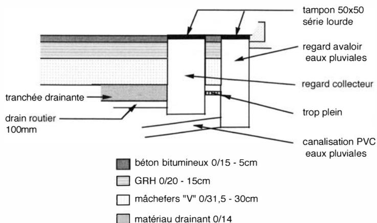
Figure 2 : Dispositif permettant le suivi environnemental
