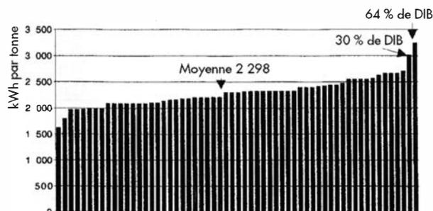
**Figure 1 : Pouvoir calorifique inférieur des déchets incinérés**
