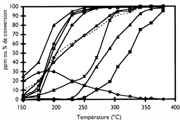
**Figure 4 : Évolution des conversions des COV du mélange modèle M2 avec la température de la réaction sur un élément cylindrique de monolithe du catalyseur COM-I. En ppm : O Acétaldéhyde. % de conversion : ■ Dichlorométhane, □ Toluène, ▲ Éthanol, ◇ Méthyléthylcétone, X Acétate d'éthyle, ● Benzène, ◆ Xylène, △ Cyclohexane, -- Conversion totale**
