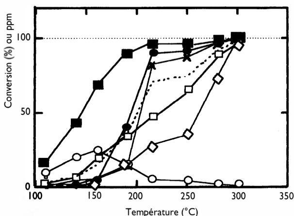
**Figure 2 : Évolution des conversions des COV du mélange modèle MI avec la température de la réaction sur un élément cylindrique de monolithe du catalyseur COM-I. En ppm : O Acétaldéhyde. % de conversion : ■ Éthanol, □ Méthyléthylcétone, ◇ Acétate d'éthyle, X Benzène, ● Toluène, --- Conversion totale**
