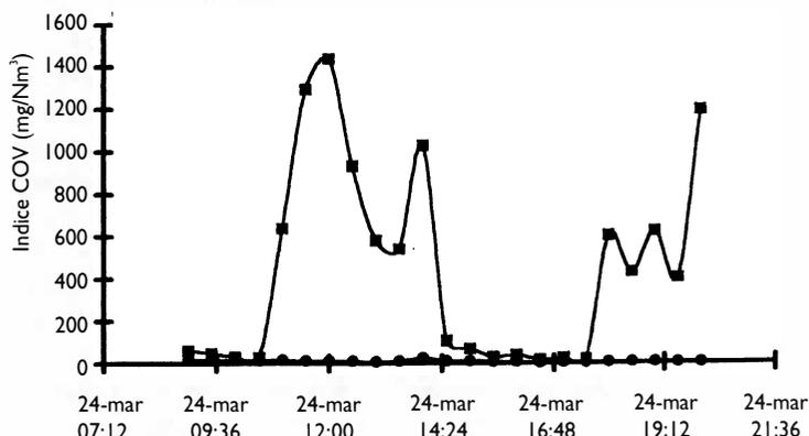
Figure 5 : Évolution des indices COV en amont (■) et en aval (●) du catalyseur le 68<sup>ème</sup> jour de fonctionnement
