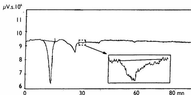
Figure 5 : Réponse de l'installation avec le manomètre EFFA
