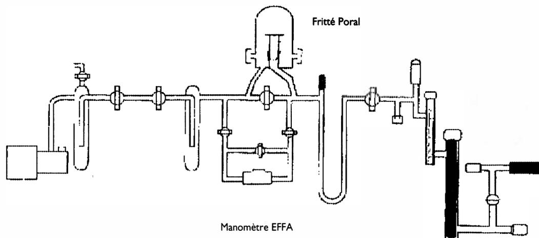
Figure 3 : Nouvel appareillage de microsublimation
