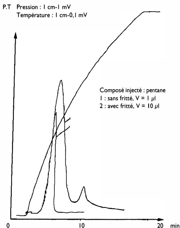
Figure 4 : Comparaison de la réponse initiale et avec diminution du pompage
