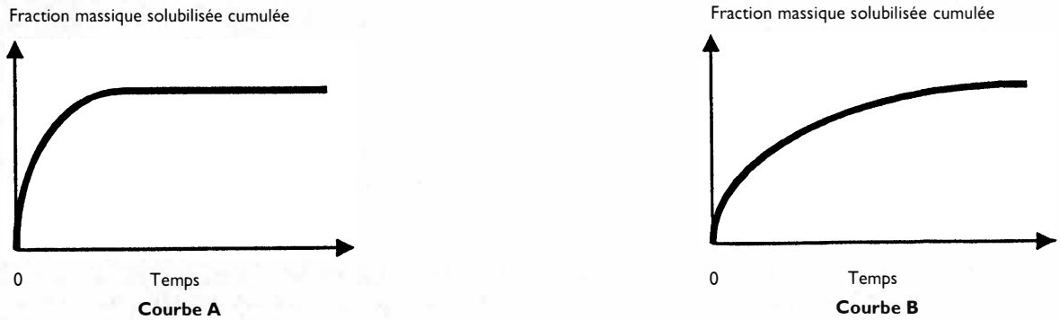
Figure 2 : Fraction cumulée d'un élément solubilisé par lixiviation à l'eau déminéralisée du déchet traité
