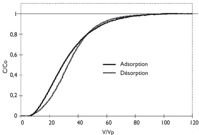
(b) Comparaison des courbes d'adsorption et de désorption modifiée (1-C/C0) du naphtalène à une concentration égale à 80 % de sa solubilité dans l'eau.
