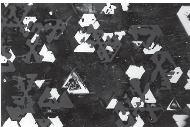
Figure 2: Cristaux dendritiques de hercynite (gris) avec des surcroissances de cristaux d'ulvöspinelle (crème). Immersion, lumière polarisée et analysée (LPA) grossissement x320
