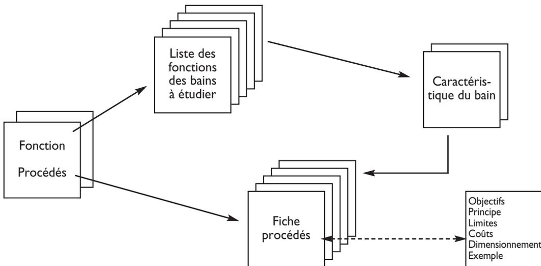
Figure 3 : Schématisation du fonctionnement de l'outil Recycle©
