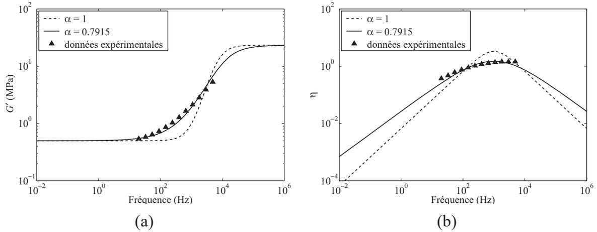
**Figure 1.** Courbes maîtresses du matériau viscoélastique ISD112 à 27°C : (a) partie réelle du module de cisaillement  $G'$  et (b) facteur de perte  $\eta$
