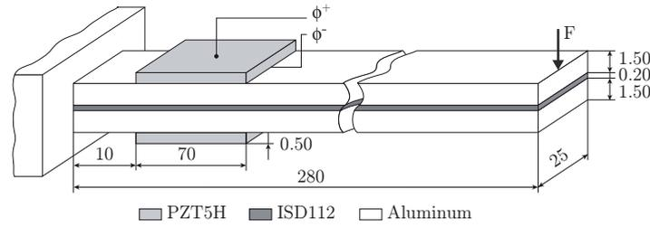
**Figure 2.** Caractéristiques de la poutre sandwich (en mm)
