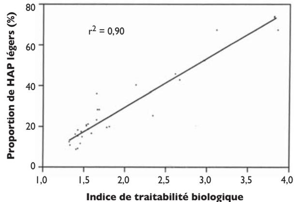
Figure 5 : Relation entre la proportion d'HAP légers (2-3 cycles) et l'indice de traitabilité biologique (A<sub>254</sub> / A<sub>288</sub>)
