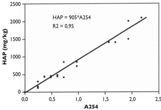
Figure 3 : Calibration initiale du kit
