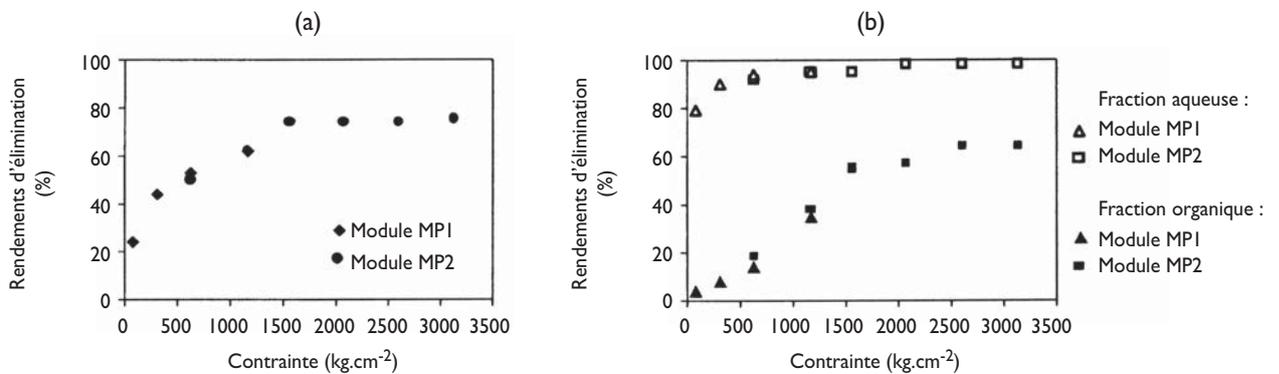
Figure 10 : Rendements d'élimination de la fraction organique de la boue à huile entière (a) et des fraction aqueuse et organique de la boue à fluide aqueux (b)
