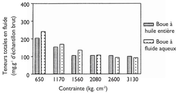
**Figure 11 : Influence de la nature des boues de rectification sur les teneurs résiduelles de la phase liquide**
