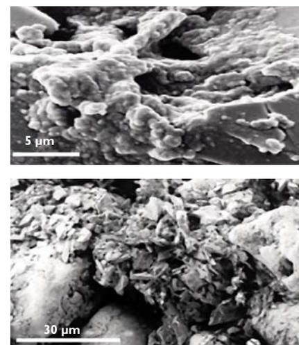
Figure 9 : Photographies MEB de la liaison phosphogypse-limon
