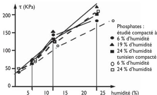
Figure 6 : Courbes intrinsèques (cisaillement)
