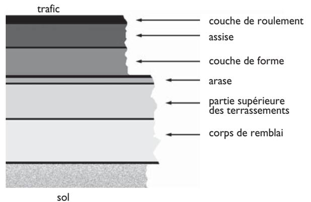
**Figure 4 : Structure d'une chaussée**
