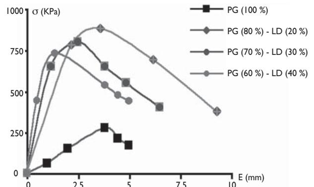
Fig 8 : Courbes de résistance à la compression
