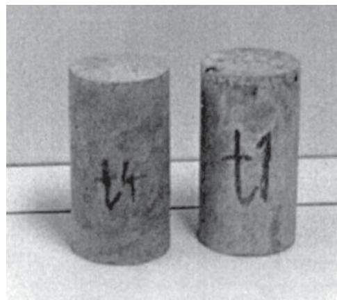
Figure 2 : Eprouvettes cylindriques de béton t1 : Eprouvette à base de granulats naturels t4 : Eprouvette à base de graviers recyclés à 100 %
