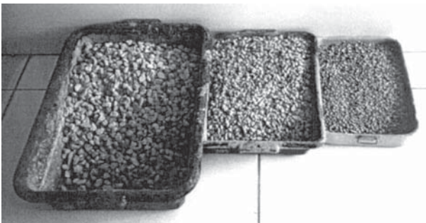
Figure 1 : Graviers recyclés issus d'une démolition sélective
