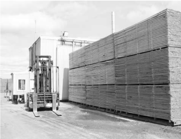
FIGURE 2 – Exemple d’une chargeuse frontale utilisée dans la manutention de paquets de bois
