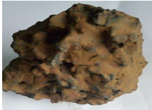
Photo n° 5 : Scorie de fer d'un fourneau
