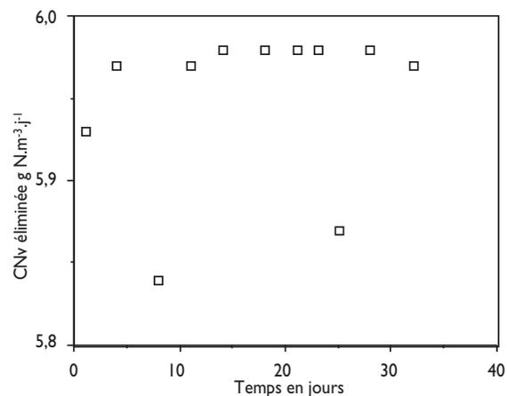
**Figure 5 : Évolution de la charge azotée (N) volumique éliminée en fonction du temps (charge appliquée = 5,98 gN.m<sup>-3</sup>.j<sup>-1</sup>)**
