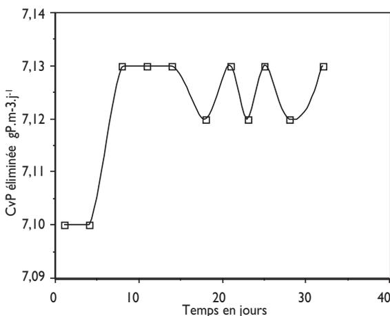
**Figure 3 : Évolution de la charge volumique phosphorée éliminée en fonction du temps (culture en continu, sortie C1). (charge appliquée = 7,2 P.m<sup>-3</sup>.j<sup>-1</sup>)**
