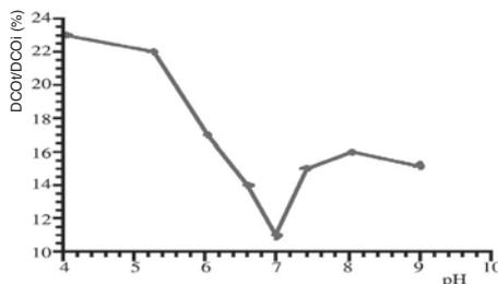
Figure 2 : Variation du rapport (DCOt/DCOi) en fonction du pH de coagulation-floculation par le sulfate d'aluminium.
