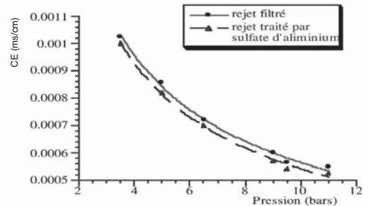
nanofiltration pour l'effluent filtré sur sable et celui traité par le sulfate d'aluminium.
