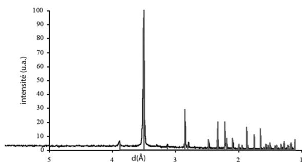
Figure 3 : Spectres de diffraction des rayons X du solide obtenu lors de l'addition d'H<sub>2</sub>SO<sub>4</sub> (excès de 100 %).
