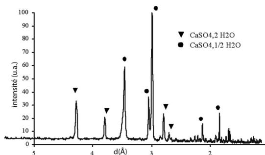
Figure 4 : Spectres de diffraction des rayons X du solide obtenu lors de l'addition d'H<sub>2</sub>SO<sub>4</sub> (proportions stœchiométriques).
