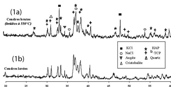
Figure 1 : Spectres de diffraction des rayons X (DRX) des cendres brutes et lavées
